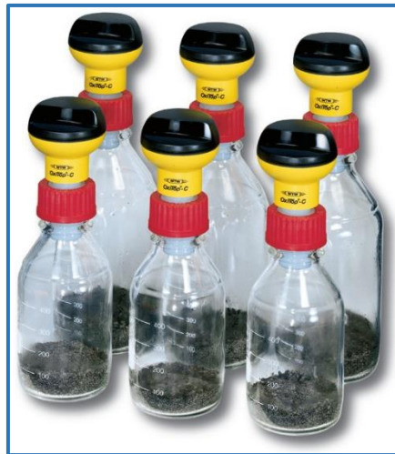
5. ábra: A zárt palackos manometrikus oxigén-meghatározáshoz használt apparátus
