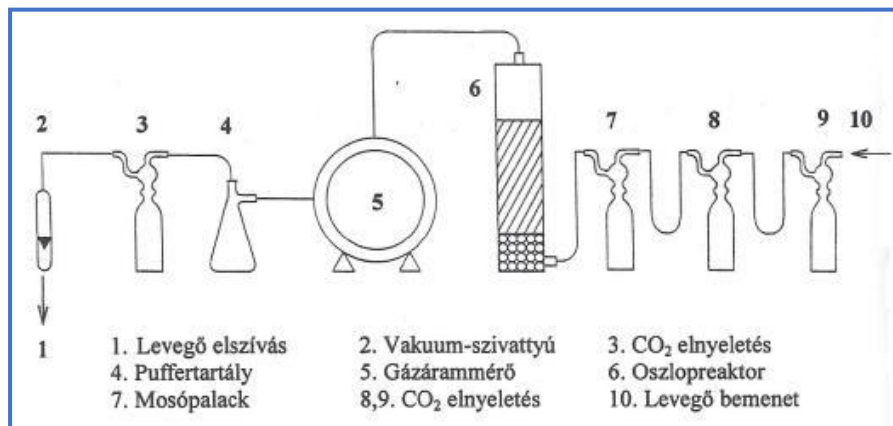
6. ábra: A dinamikus talajlégzésmérés során használt mérőrendszer összeállítása
