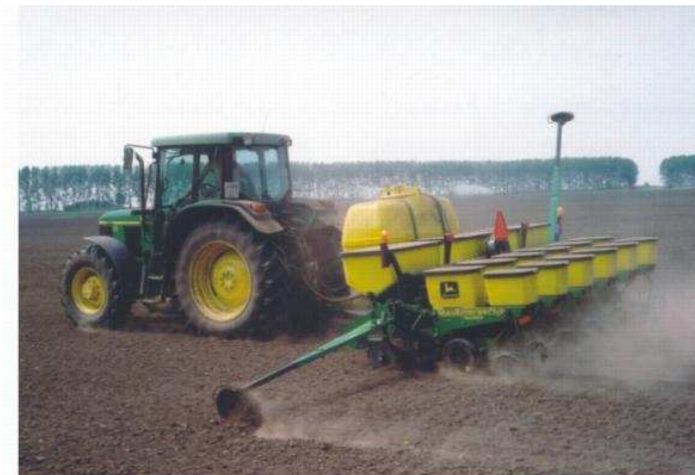
1. kép John Deere 1750 vetőgép, vetéssel egy menetben történő inszekticid és herbicid kijuttatással
