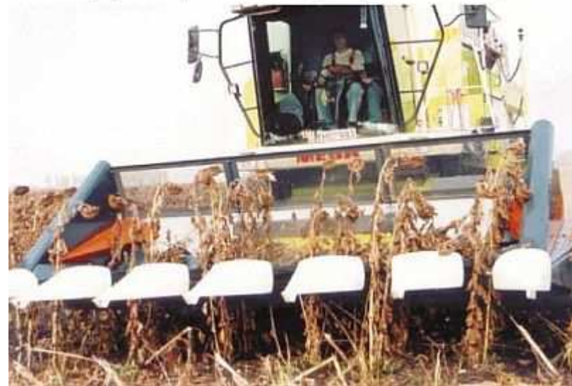
2. ábra: Új fejlesztésű, 6 soros NAS napraforgó betakarító adapter
