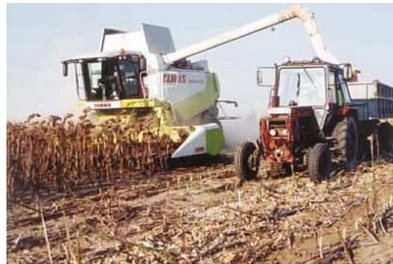
3. ábra: 12 soros SUNSPEED 12-75 adapter vágás közben
