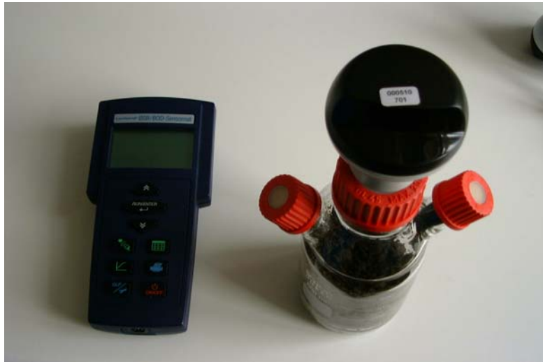
10. ábra: Kézi adatrögzítő és reakcióedény az érzékelő fejjel
