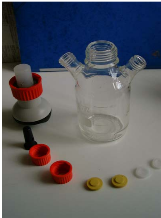
9. ábra: Mérőfej, mérőedény és tömítések
